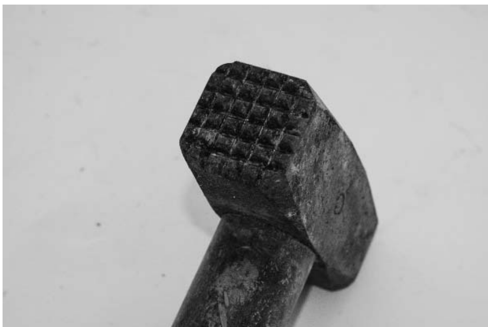
Fot. 3. Obuch groszkownika, narzędzia do fakturowania powierzchni.
