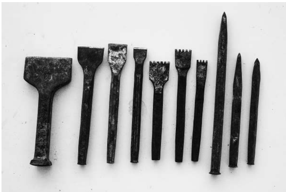
Fot. 6. Dłuta kamieniarskie, od lewej: szulerak, dłuta płaskie, gradziny, szpice.
