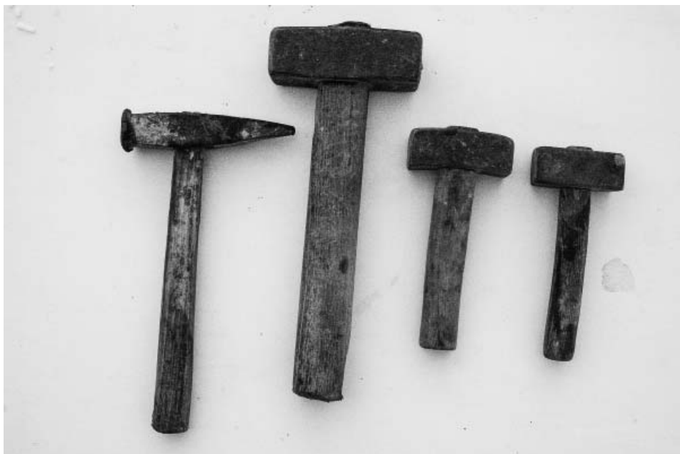
Fot. 2. Młotki kamieniarskie, od prawej: pucka liternicza – 0,8 kg, pucka zwykła – 1,2 kg, pucka duża – 2,5 kg, „oskard” mały.
